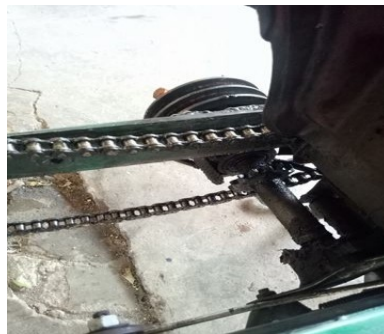
ภาพที่ 5 แสดงชุดตัวต้นกำลังจากรถจักรยานยนต์
