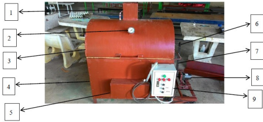
ภาพที่ 3 ส่วนประกอบเครื่องอบแห้งเมล็ดกาแฟแบบถังหมุน
